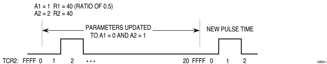
Figure 6 Updated Parameters When ANGLE1 ≤ ANGLE2
